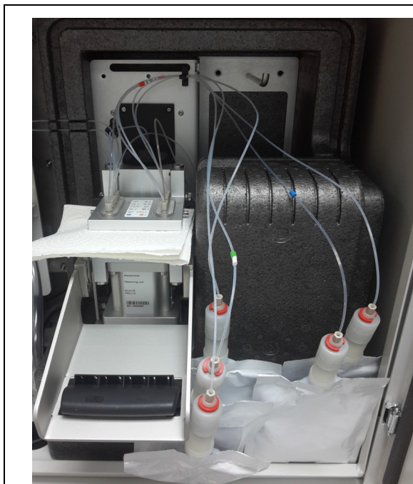
figur 5-20 Absorberende papir i MultiPort-ventilens opsamlingsbeholder
