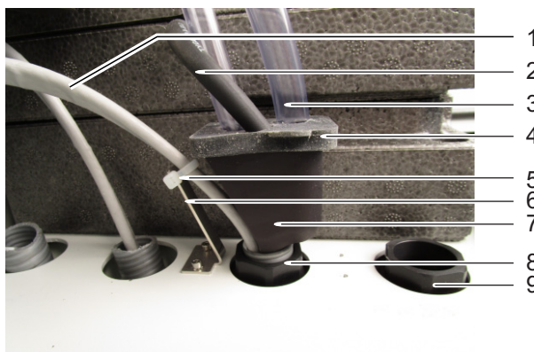
figur 3-25 Opsamlingstragt til almindelig bortledning af alle væsker
